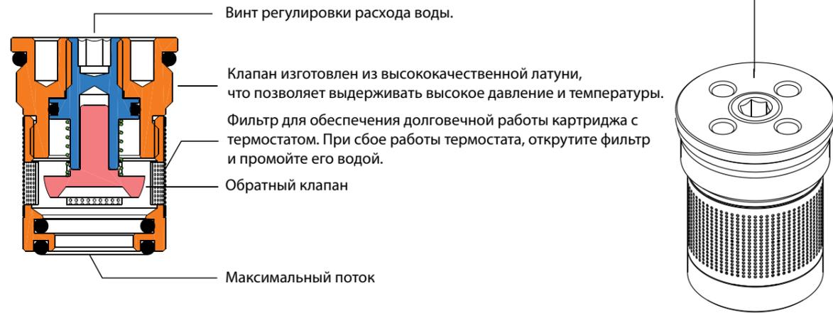
Винт регулировки расхода воды.
