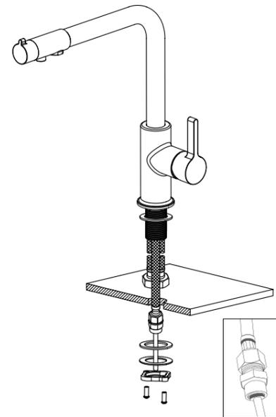
Штуцер для соединения с трубкой фильтра (входит в комплект)
