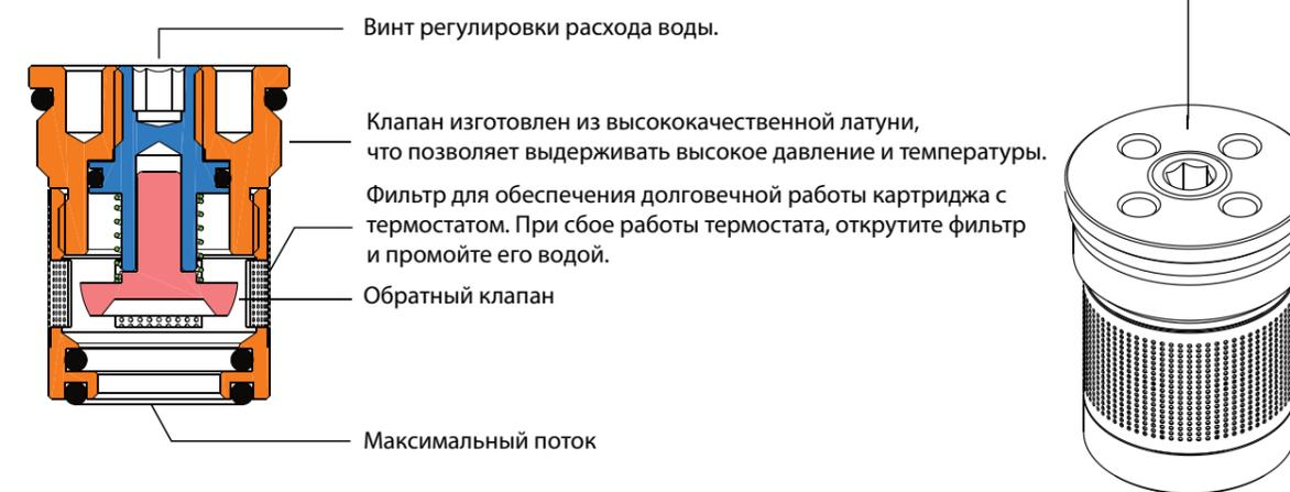
**STOP Внимание:** обратный клапан отрегулирован на фабрике и открыт на максимальный поток воды.
