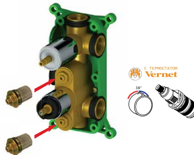
Для долговечной работы картриджа с термостатом в конструкции смесителя установлены отдельные фильтры для горячей и холодной воды. При сбое работы термостата, открутите фильтры и промойте их водой.
