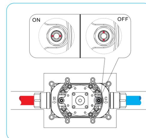
Клапаны отдельно для холодной и горячей воды, что позволяет проверить все соединения на герметичность до заливки стяжки.
