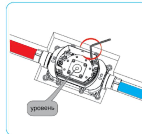
В конструкции монтажной коробки предусмотрен датчик уровня, который облегчает процесс выравнивания при установке.
