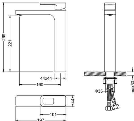
Промойте трубы для подачи воды, что бы удалить инородные вещества. Подключите подачу воды, убедитесь, что подача горячей воды слева, а холодной справа. Включите воду и проверьте работу смесителя на предмет утечек.
