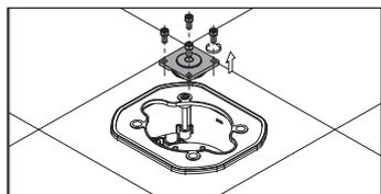
Открутите винты, извлеките пластину с датчиком уровня
