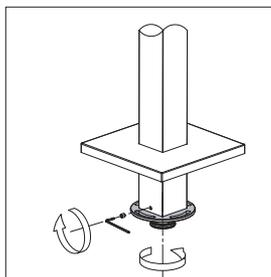
Накрутите фиксатор на трубу, а затем зафиксируйте винтом сбоку.
