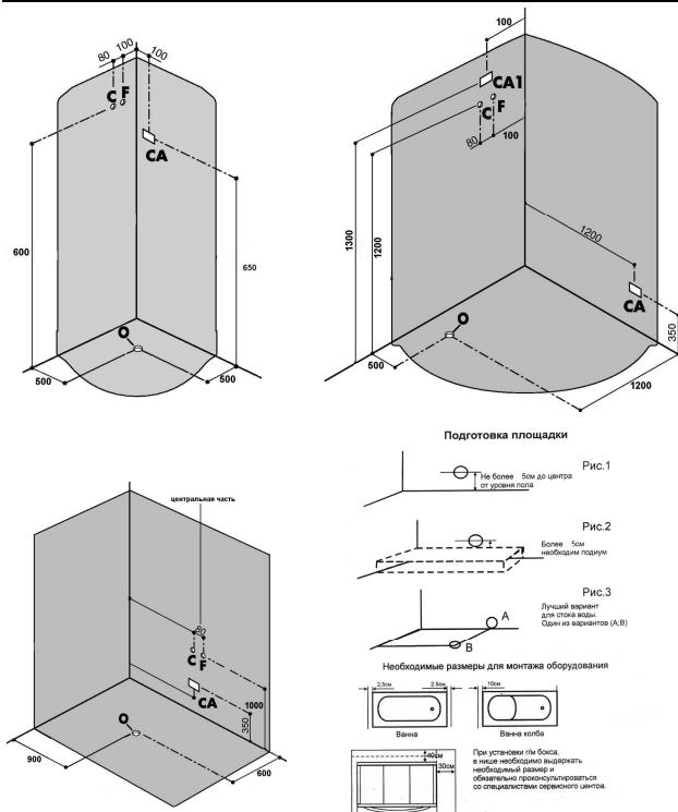
С. Горячая вода: труба, пластина G1/2, 600 мм над F. Холодная вода: труба, покрытая цинковыми пластинами G1/2, 600 мм над полом.
