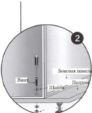
Поместите стенку кабины на нижнем поддоне (убедитесь в том, что стена стоит перпендикулярно к нижнему поддону). Используйте 4 болта с плоскоконической головкой M5x35, шайбы диаметром 5 и гаек M5 для того, чтобы временно закрепить стенку кабины на нижнем поддоне (не закручивайте плотно, чтобы можно было отрегулировать положение; более плотно вы сможете закрутить гайки на более позднем этапе установки).
