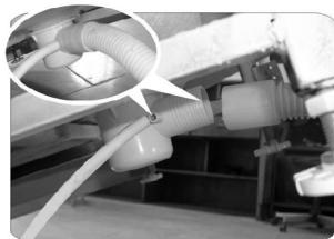
Поднимите заднюю часть поддона. Соедините большой конец сливного шланга с коленом сливного канала под нижним поддоном и вставьте противоположный конец в сливное отверстие в полу. Соедините армированный шланг диаметром 8.8 см боковым ниппелем колена сливного шланга.
