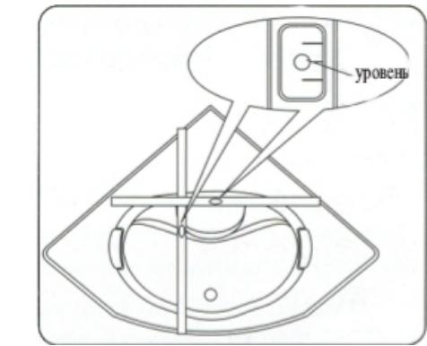
Установите поддон в нужное положение. Используйте уровнемер, чтобы выровнить положение поддона. (Этот шаг очень важен). Если не выровнить положение поддона, душевая кабина будет установлена криво и не будет устойчива, соответственно резьбовые отверстия (отверстия под винты) не будут находиться на одной линии друг с другом. Если поддон стоит неровно, отрегулируйте его положение с помощью нижних болтов с резиновыми наконечниками. Затем заблокируйте контргайки.
