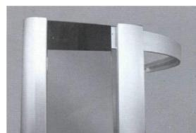
Используйте 16 самонарезающих болтов, чтобы прикрепить к двум опорным стойкам и к дугообразным направляющим. Вставьте гребни уплотнения в зазор между неподвижным стеклом и опорными стойками.
