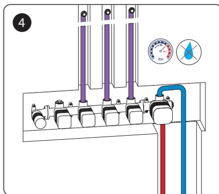
Проверьте все соединения на герметичность.
