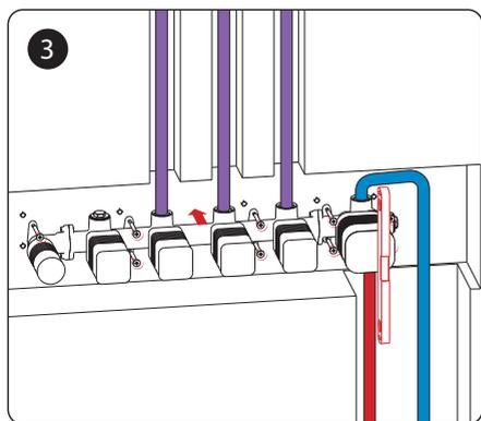
Используя уровень, установите блок на стену и отметьте положение крепежных выступов, просверлите отверстия и прикрепите встраенный блок к стене с помощью винтов и анкеров.
