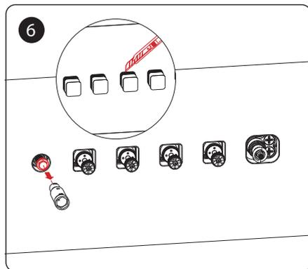
Следуя линии разреза на коробке, отрежьте выступающую часть коробки. Снимите заглушку с помощью сервисного ключа.
