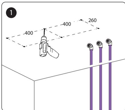
Используйте раму кронштейна в качестве шаблона. Отметьте линию установки карандашом.
