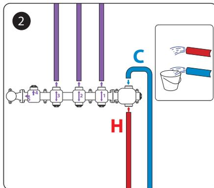
Подсоедините корпус встраенного блока к водопроводу, используя соответствующие фитинги, (С) – входное отверстие для холодной воды, а (Н) – входное отверстие для горячей воды.
