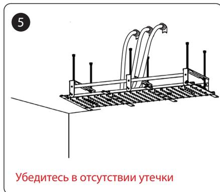
Соедините шлангами трубы встроенного блока с водовыпусками в лейке в соответствии с режимами подачи воды.
