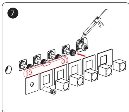
После укладки облицовки нанесите водостойкий герметик на край плитки. Установите соединительную трубку держателя ручной лейки. Наденьте декоративный отражатель на соединительную трубку. Установите декоративные гильзы на картридж термостата и диверторы. Установите декоративные наклейки в соответствии с символами на лицевой части наклейки.
