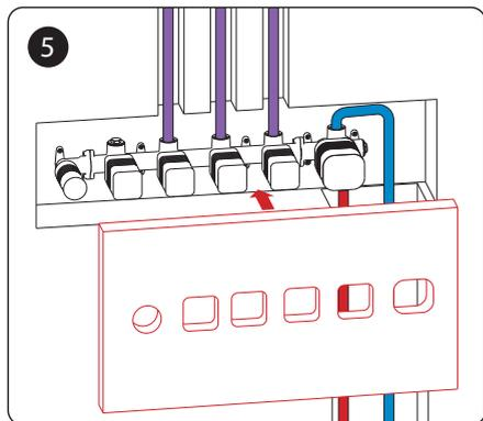
Используя шаблон, вырежьте отверстие в плитке, затем соответствующим образом уложите плитку. Не снимайте защитные крышки до завершения всех отделочных работ. Это защитит блок управления от попадания пыли.
