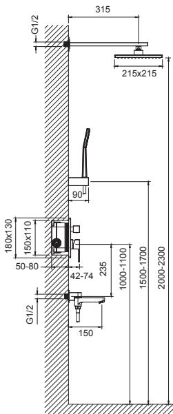
Определите точное место установки смесителя.
