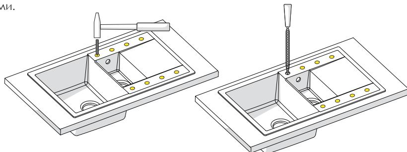
1.4. Для установки смесителя и аксессуаров с посадочным диаметром более 35 мм отверстие в мойке может быть увеличено. Данная процедура прописана в инструкции по монтажу нестандартных смесителей и аксессуаров.
