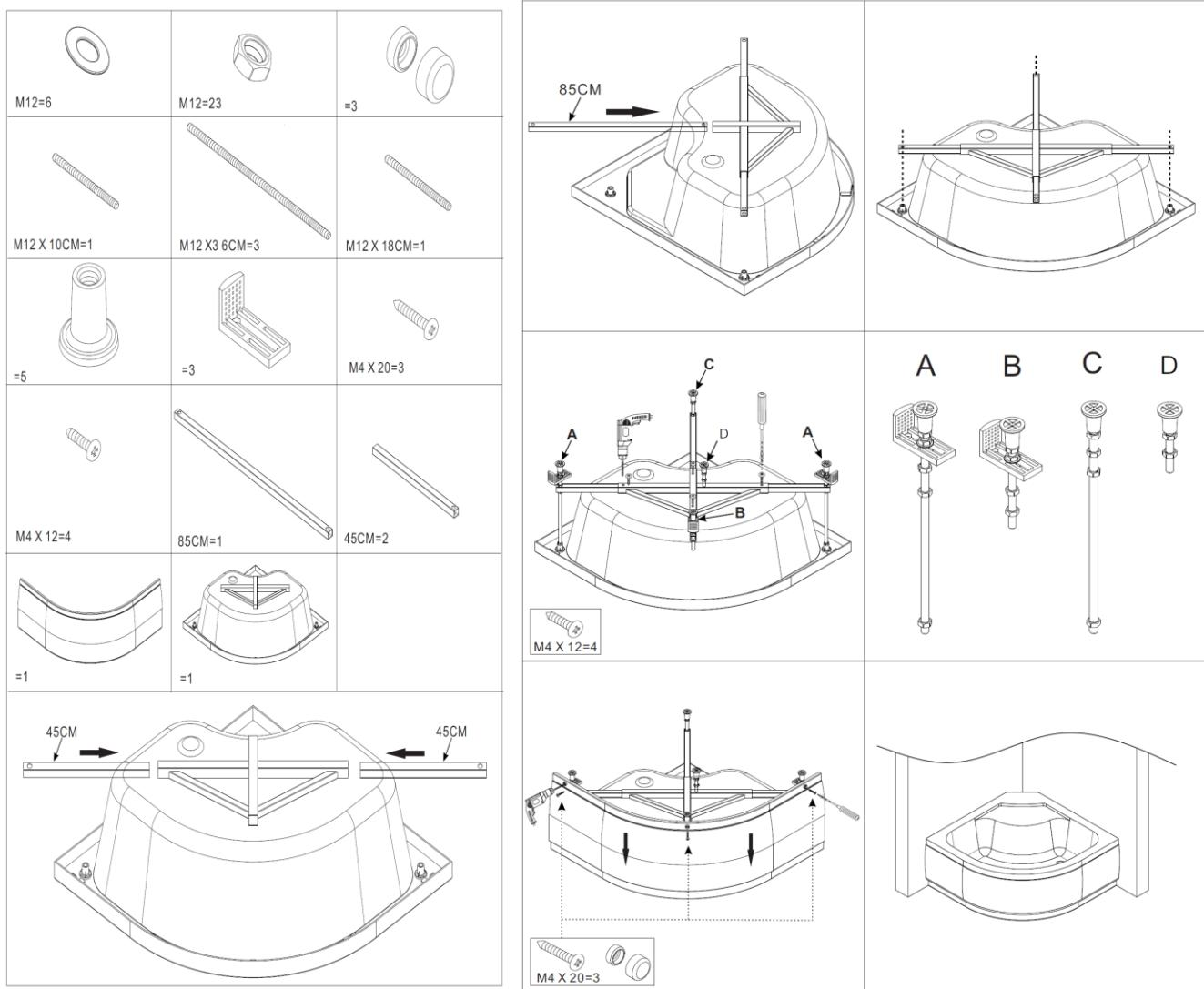
Если поддон с каркасом уже частично собраны , необходимо установить все остальные части предлагающиеся для сборки и протянуть ключом все винтовые соединения. Ножки служат для выставления поддона по уровню , по этому под несущую конструкцию необходимо установить дополнительные упоры.
