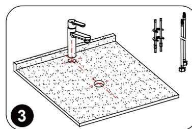
Установите раковину столешницу и определите места установки смесителя и раковины.
