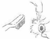
2. Поверните и снимите фильтр. Поставьте таз или другую ёмкость под угловой клапан — вытечет небольшое количество воды.
