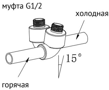
2. Определите место установки смесителя, сделайте углубление в полу и подведите воду как показано на схеме.
