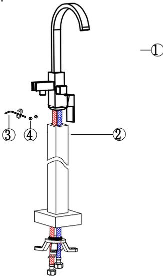
5. Накрутите фиксатор на трубу, соедините шланги гибкой подводки с муфтами.
