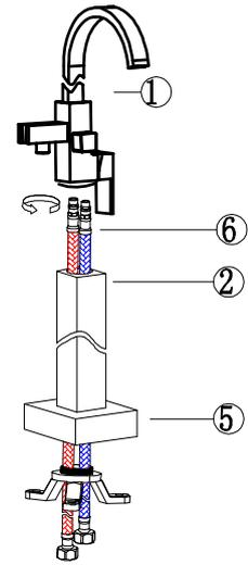
4. Соедините корпус смесителя с трубой и закрутите винты шестигранным ключом.
