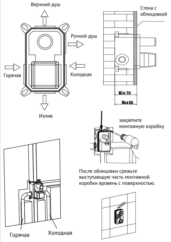
После облицовки срежьте выступающую часть монтажной коробки вровень с поверхностью.
