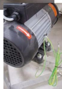
6. Подсоединение к электропитанию: используйте мультиметр для проверки соединения «Земляного» провода в электрической вилке с корпусом помпы и рамой каркаса, а затем соедините желто-зеленый провод с «Землей». Вставьте вилку в розетку.
