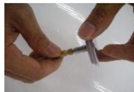
5. Очистка отверстия для забора воды: открутите накладку отверстия по часовой стрелке, снимите ее, прочистите, а потом привинтите на место.
