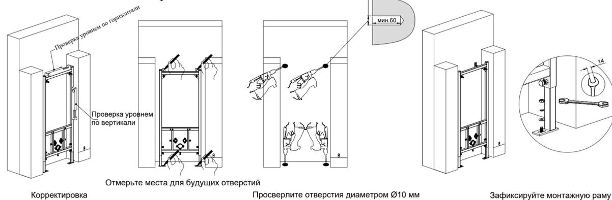
Единица измерения - мм,  $\frac{0}{\downarrow}$  = высота изделия от чистового пола(поверхность с плиткой).
