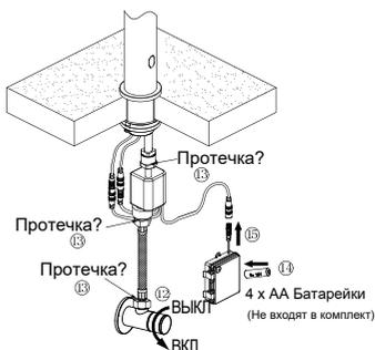
7. Вода автоматически польётся из крана после взмаха ладонью перед датчиком; когда вы уберете руки, кран остановит подачу воды.
