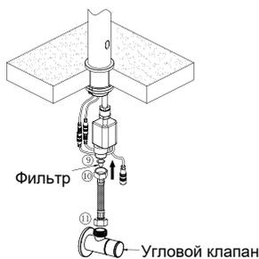
6. Включите воду и проверьте каждое соединение на отсутствие протечек. Затем установите и подключите батарейный блок.
