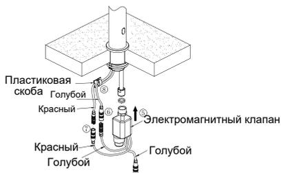
5. Соедините электромагнитный клапан и угловой клапан с помощью шланга.
