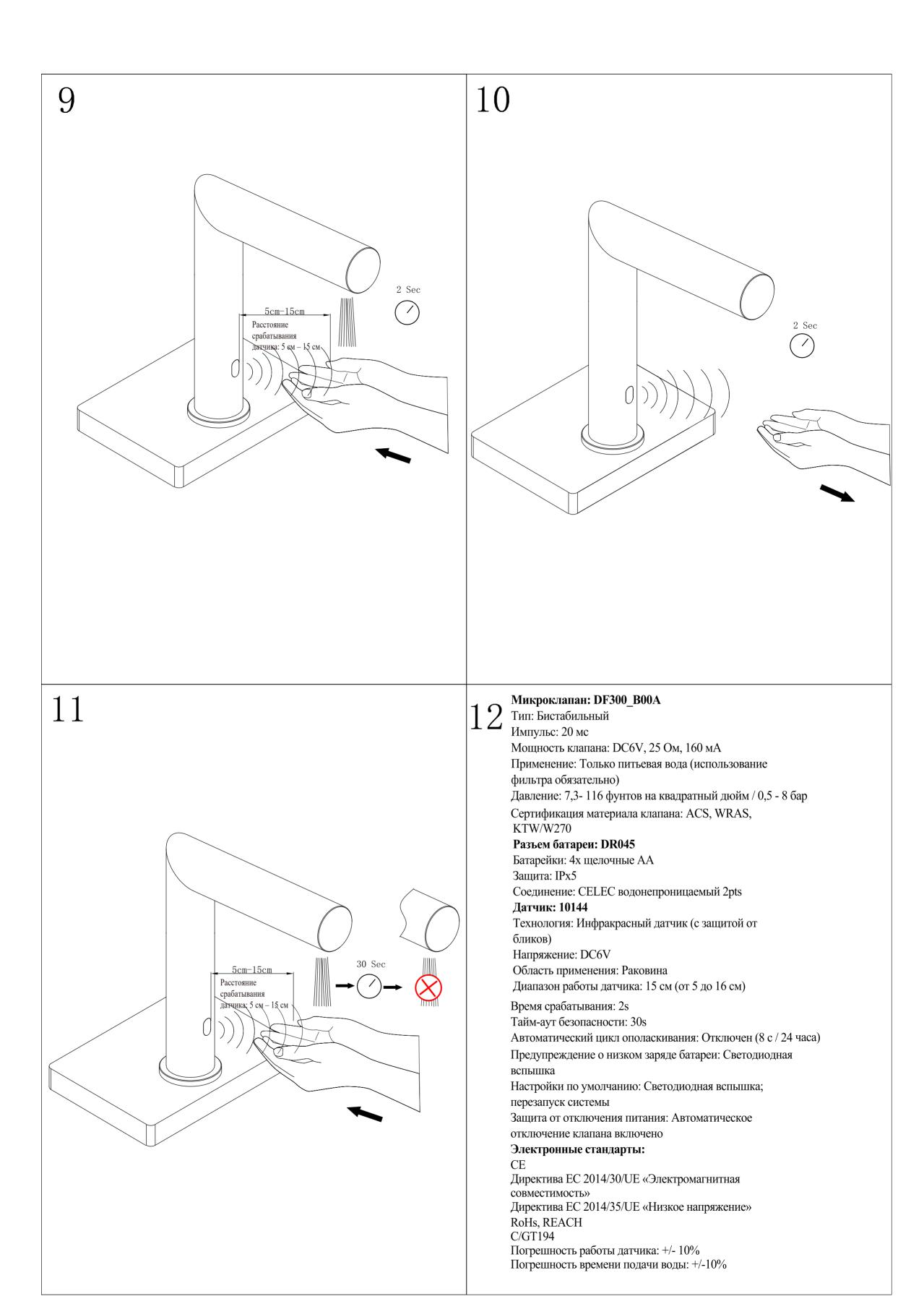
Если расстояние срабатывания датчика не подходит и требуется его регулировка,
