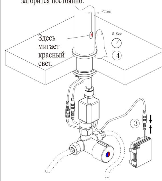
Когда красный свет горит постоянно, разместите руку на желаемом расстоянии регулировки и подождите 3 секунды; регулировка завершена, как только красный свет погаснет.
