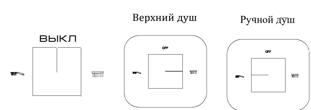
Вставьте дивертор смесителя в выемку до упора и закрутите, чтобы плотно прижать к фиксирующему винту. Нажмите на регулятор и поверните до характерного щелчка.
